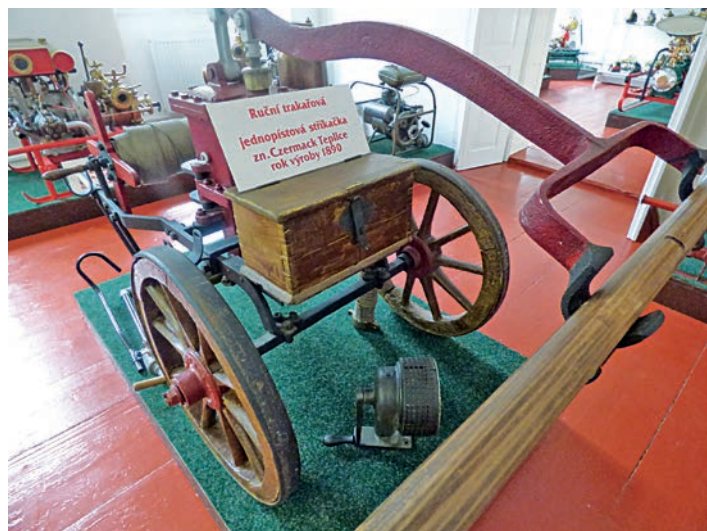
Ruční jednopístová stříkačka firmy Czermack z r. 1890 (Hasičské muzeum Krupka)
